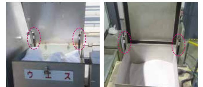
固定用ストッパー治具取付け
