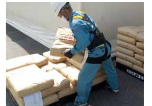
澱粉出荷業務(パワースーツ着用時)
