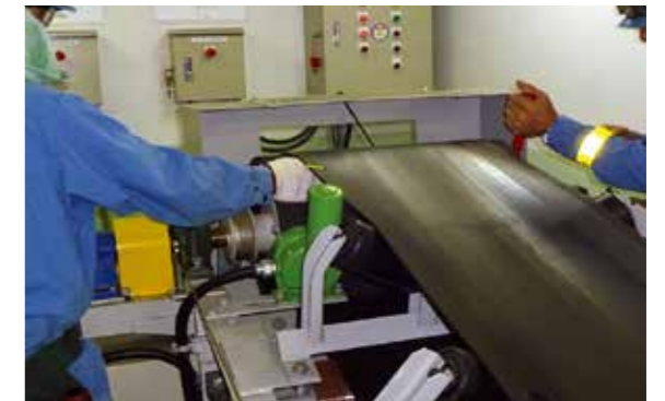
ベルトコンベヤでの挟まれ
